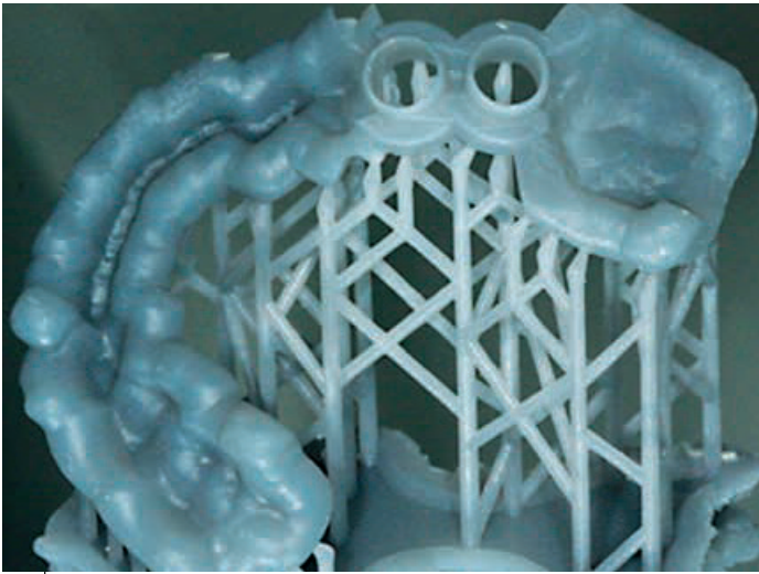
Abb. 4: Im 3D-Drucker gefertigte, chirurgische Bohrschablone aus Polymer vor dem Entfernen der Stützkonstruktion. Quelle: Dinahet
